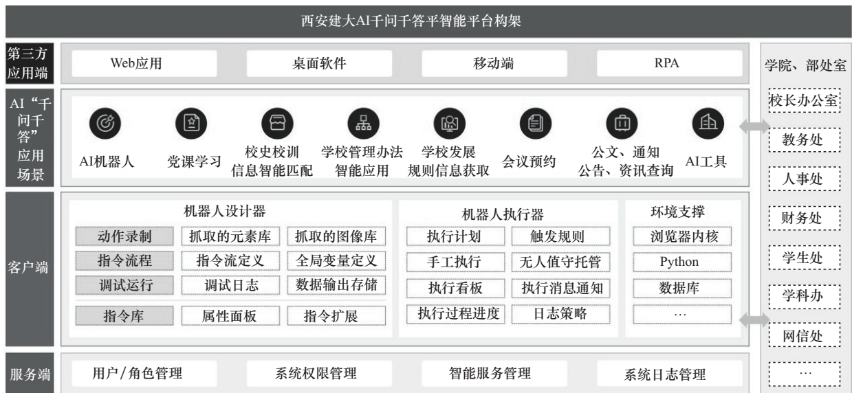
图2 AI“千问千答”智能平台整体架构
